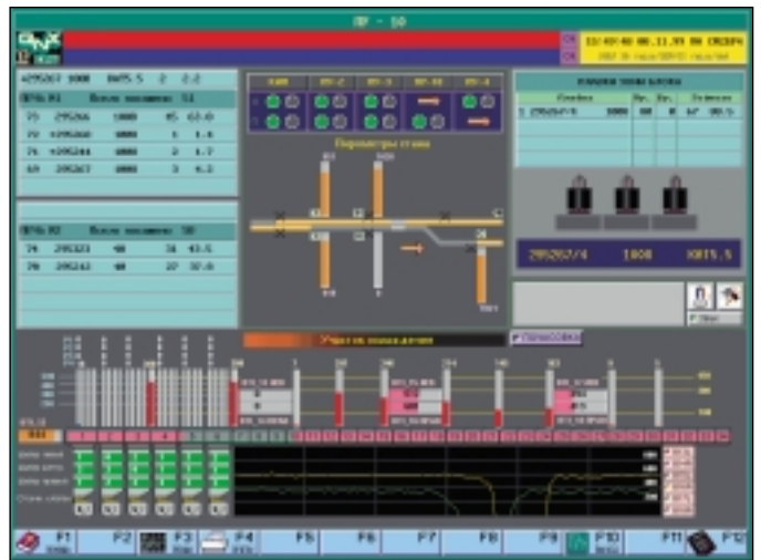
Рис. 3. Главная панель информационной системы сортопрокатного цеха для оператора поста управления линией охлаждения бунтового проката
